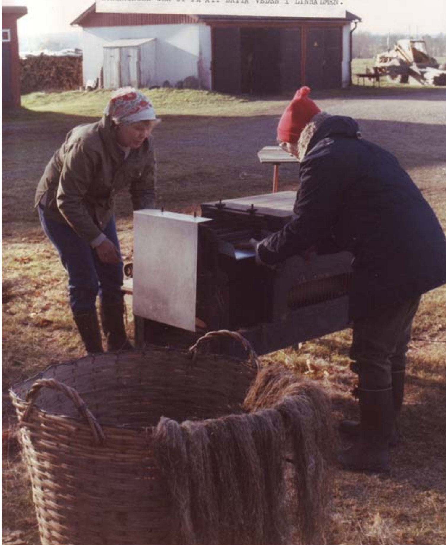
Linbråka eldriven en "helvetesmaskin" där det var lätt att fastna med fingrarna. Stor försiktighet men fort gick det att bråka. Inger Ekström och Kersin Erikols.
